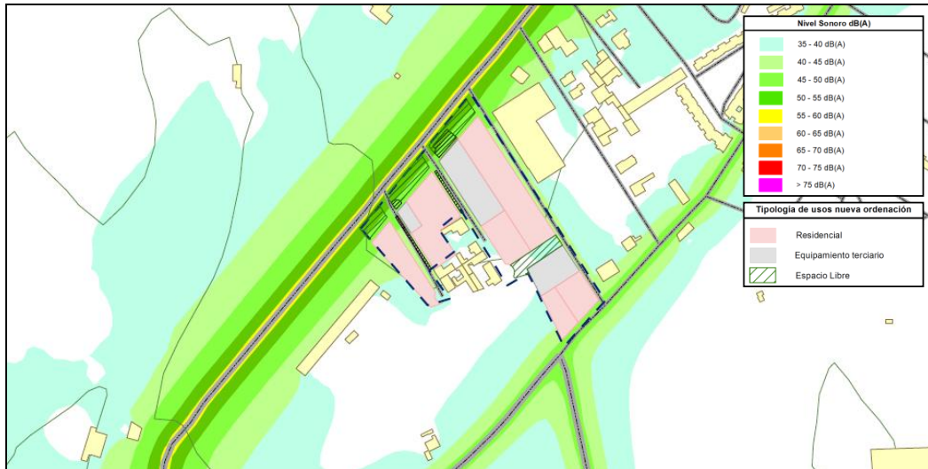
Figura 10: Mapa de niveles sonoros para la situación futura prevista en periodo noche
