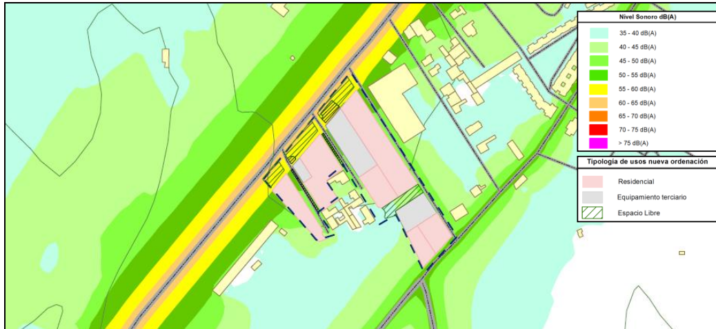
Figura 8: Mapa de niveles sonoros para la situación futura prevista estimada en periodo día
